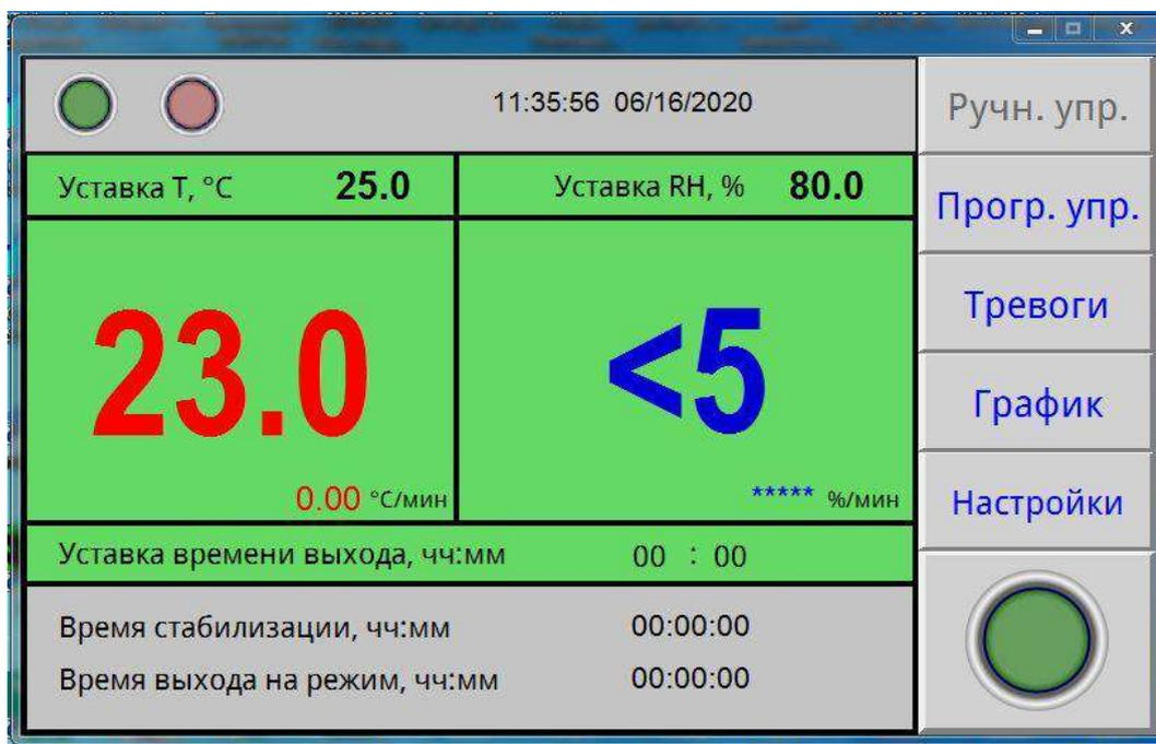
Рисунок В6 – Окно удаленного доступа к изделию через Ethernet
